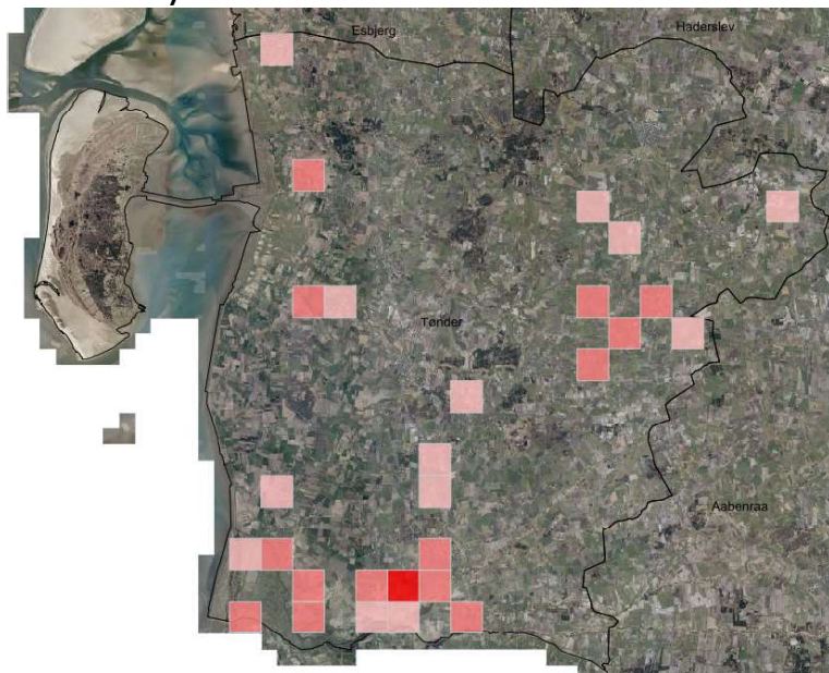
Figur 2.14: viser risikoområderne for nedbør- Rødsignatur er lige med størst risiko. Samlet set vil et stort skybrud, medfører skader på bygninger og mennesker for 2.6 mio./år Kilde: Skadesøkonomi
