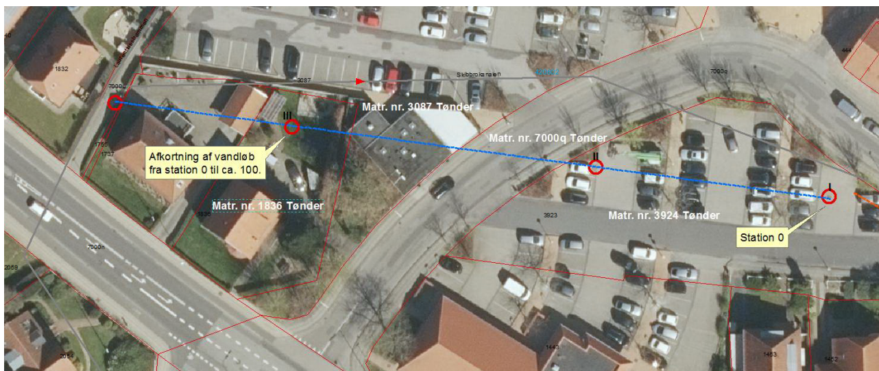
Oversigtskort 2. Blå stiplede streg er offentlige vandløb, som det ligger i marken. Grå streg er beliggenhed efter regulativet. Røde cirkler er brønde med nummer. Røde streger er matrikelskel. Vandløbet afkortes og sløjfes fra station 0 til station 100.
