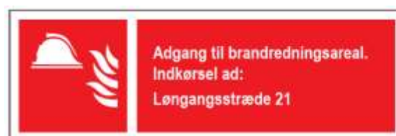
Figur 6 viser eksempel på skilt til angivelse af brandredningsareal i baggård med indkørsel ad anden adresse
