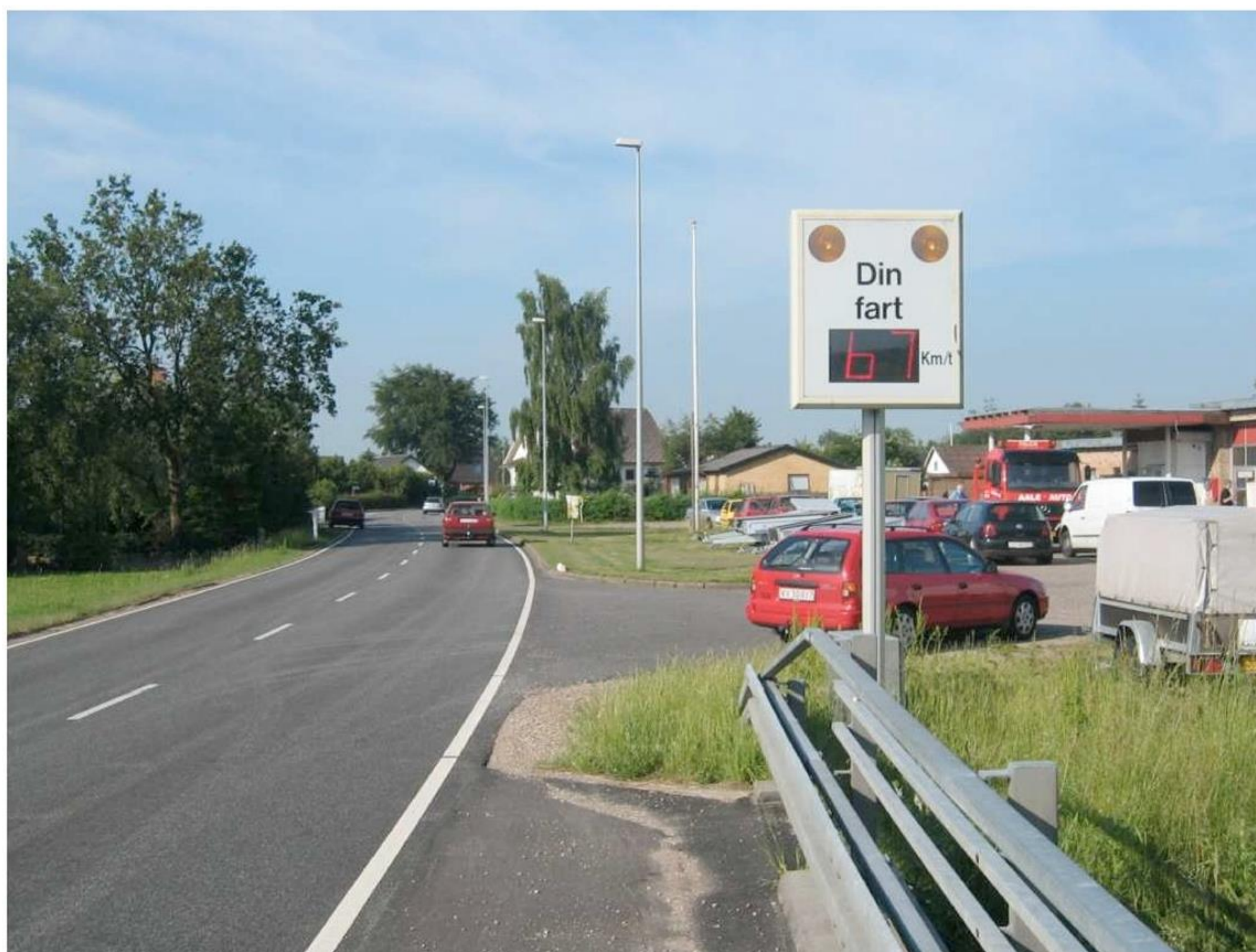
Figur 8 Eksempel på stationær fartviser placeret umiddelbart efter indkørsel til et tættere bebygget område.
