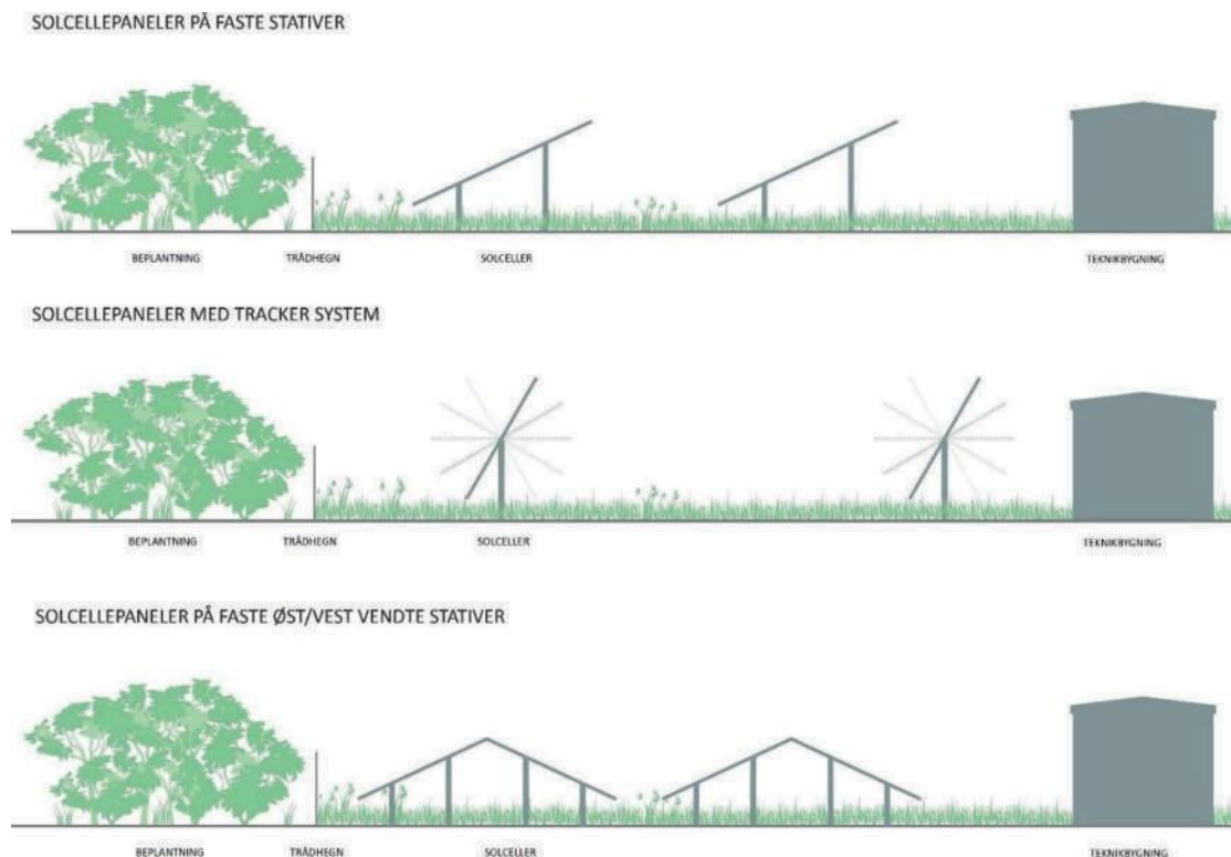
Figur 2.5-1 Eksempel på opsætning af solcellepaneler på faste stativer og tracker system. Kilde: Nytteland
