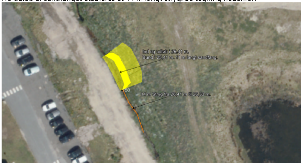
Figur 2. Tegning af sandfang og stryg.
