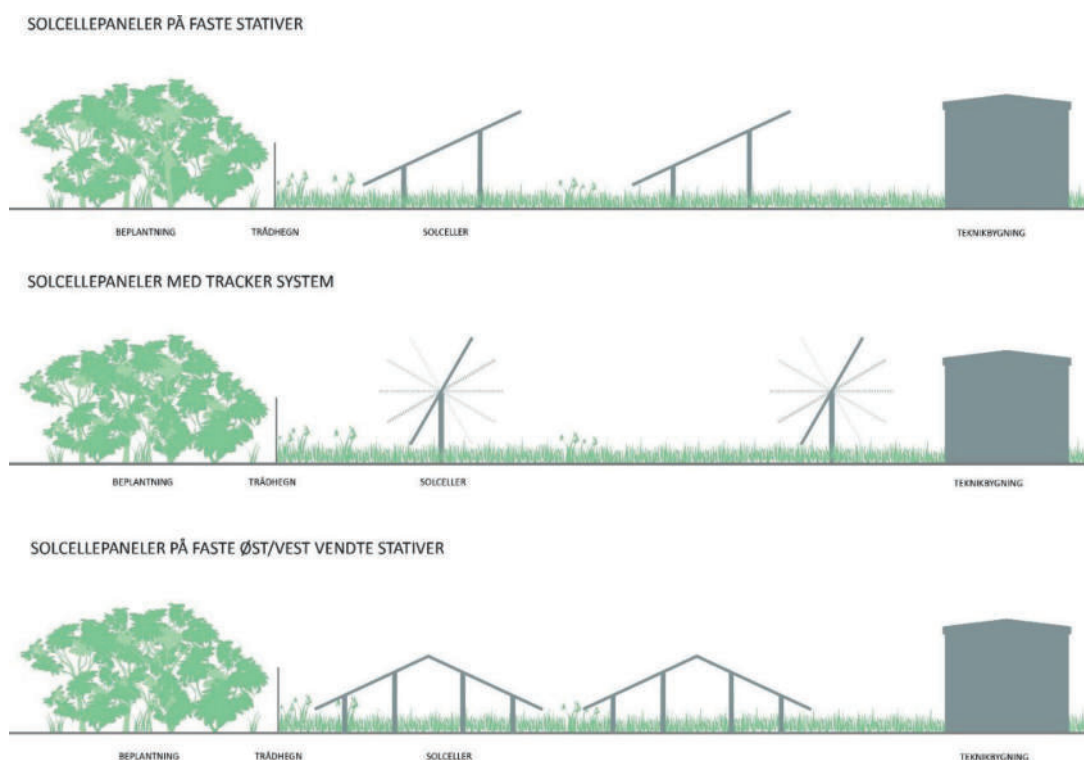
Figur 1.3 Eksempel på opsætning af solcellepaneler på faste stativer og tracker system. Kilde: Nytteland
