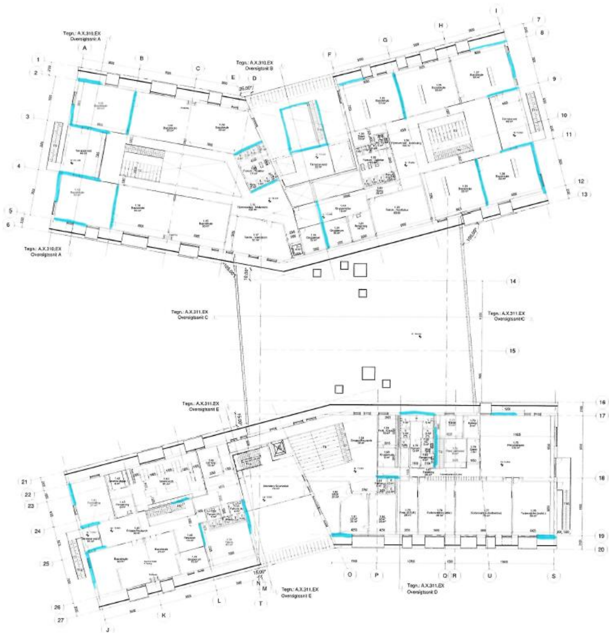
Figur 7 - Stabiliserende vægge, 1. sal
