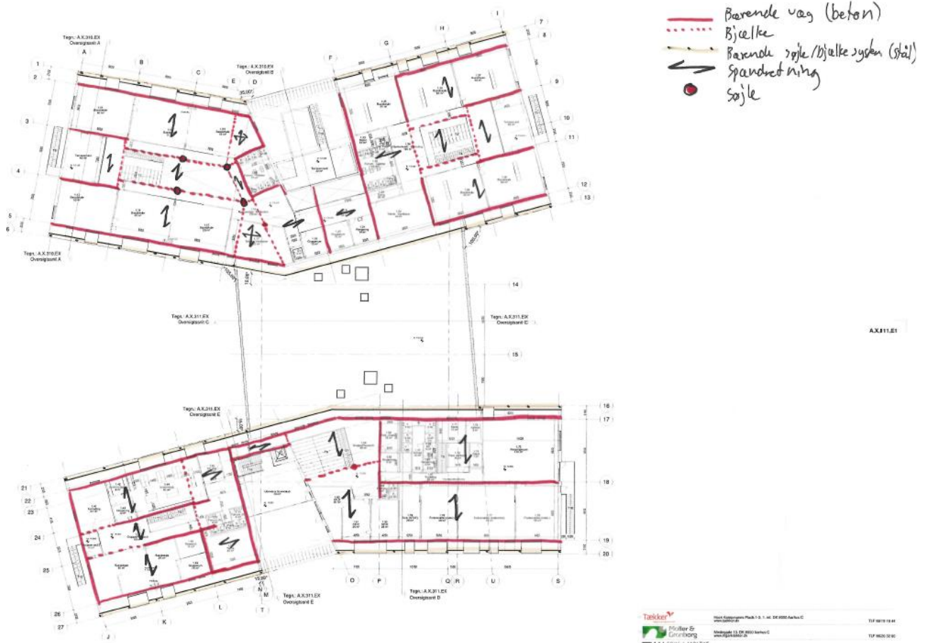
Figur 4 - Bærelinjer og spændretning, 1. sal
