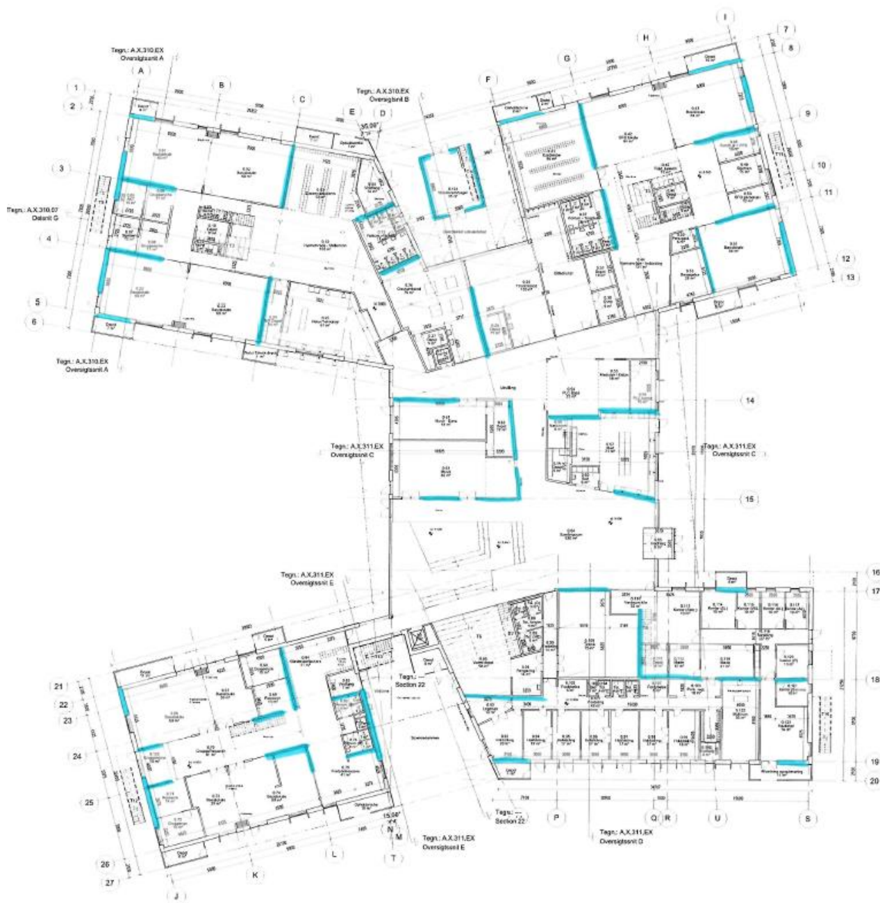
Figur 6 - Stabiliserende vægge, stue
