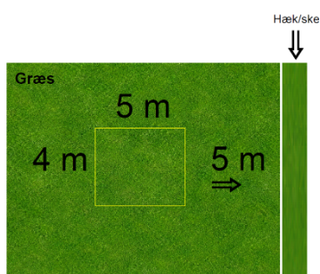
Bunkeren set ovenfra med afstand til skel.
