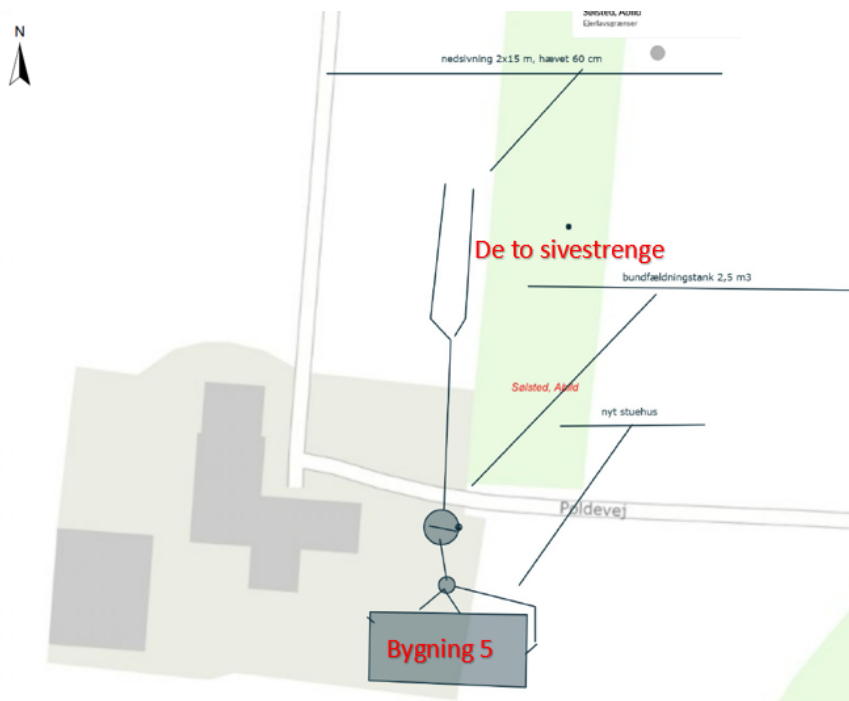
Kortoversigt over hævet nedsivningsanlæg.
