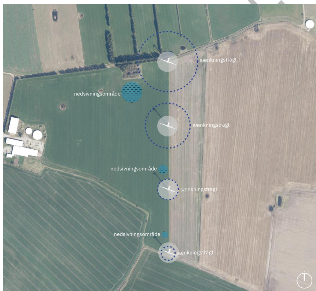
Figur8.2: Kortet viser de fire vindmølleplaceringer, placering af midlertidige volde/bassiner til inddæmning af nedsivningsområder, samt skønnede midlertidige sænkningstragte omkring vindmøllerne. (se Appendiks II)
