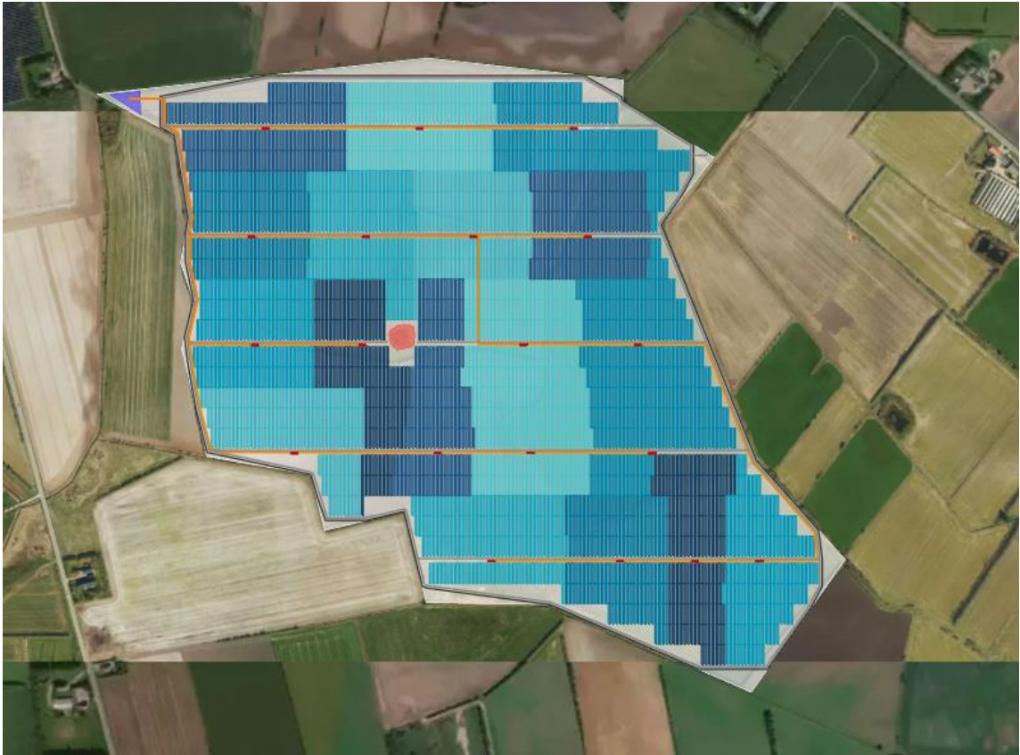
Kort 5: Foreløbigt design for solcellepark ved Løgumkloster med trackersystem.
