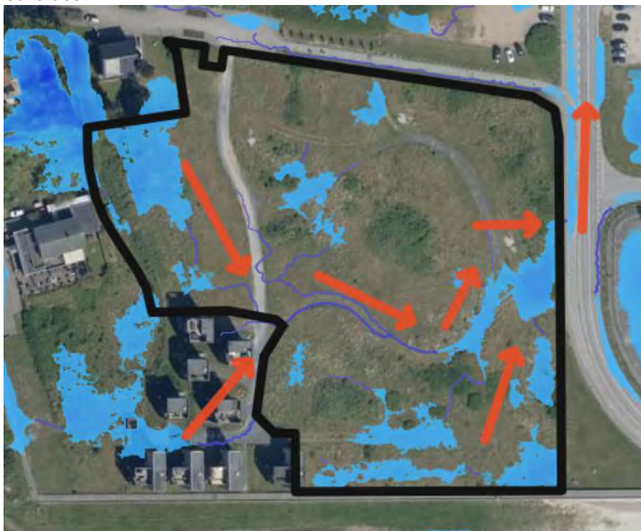
Figur 10.1 Nuværende strømningsveje. Vandets retning er markeret med røde pile /1//14//15/.
