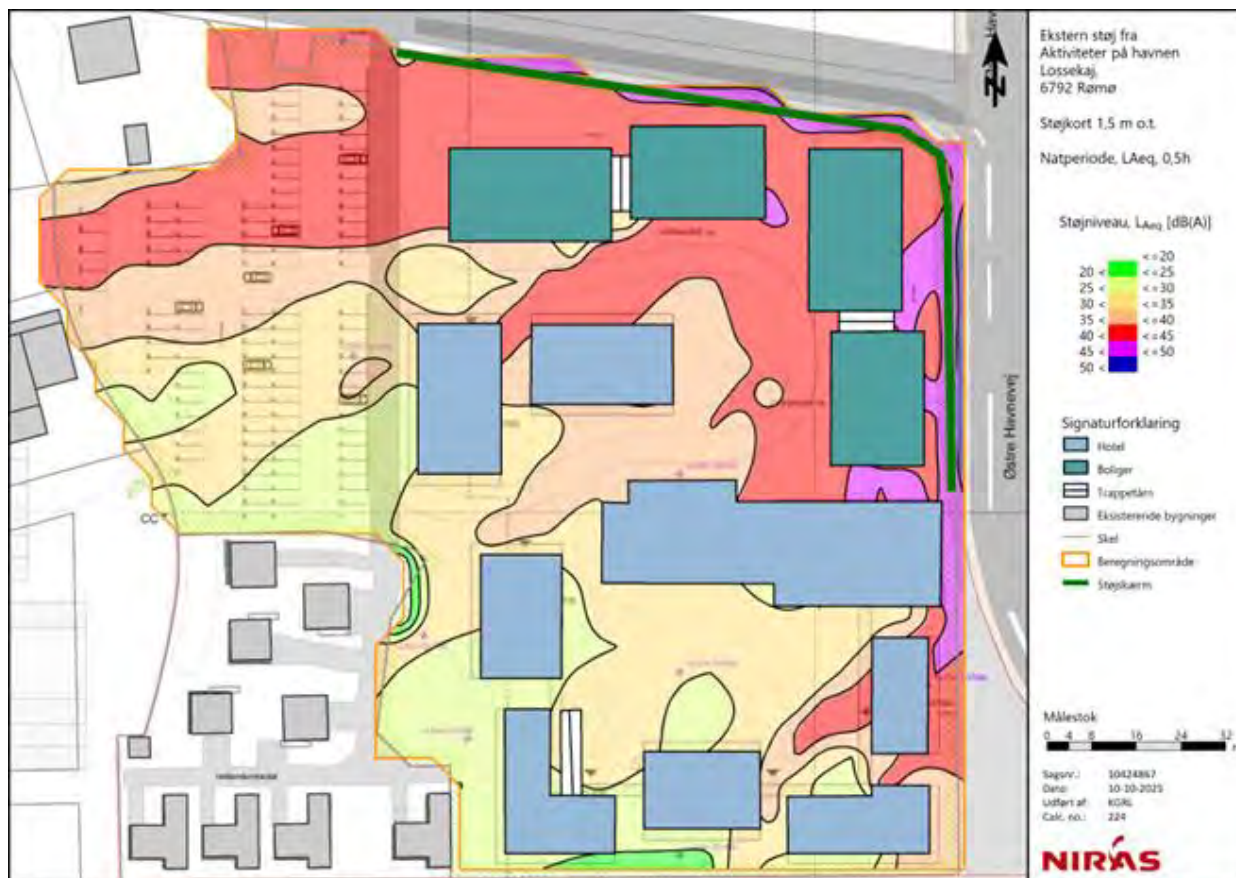
Figur 7.1: Ekstern støj fra havneaktiviteterne i natperioden, beregnet 1,5 m over terræn i planområdet. Der er indregnet en 3m høj støjskærm i skel til Østre Havnevej.
